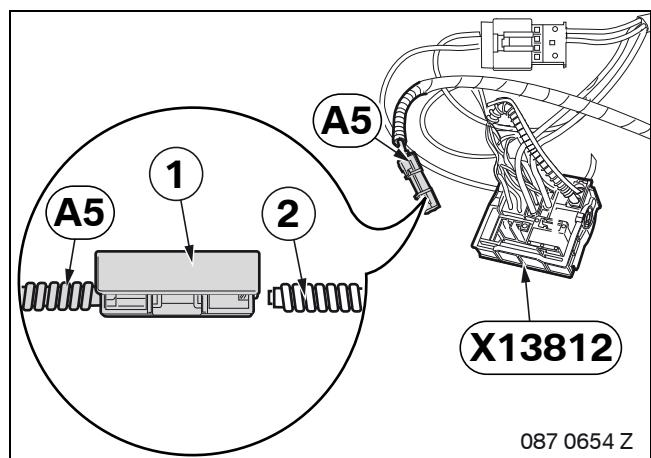
Sbloccare il connettore del cavo a fibre ottiche (1) della derivazione **A5** e infilare il cavo a fibre ottiche (2) sfilato.
