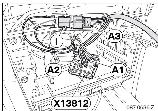
Sfilare i seguenti cavi dalla spina **X13812** (a 16 poli SW) del ricevitore della radio e infilarli nella scatola del connettore femmina **I**:
