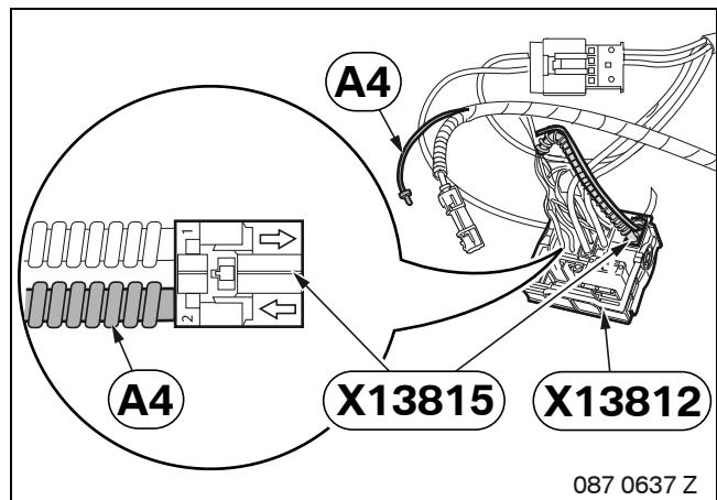
► Mantenere un raggio minimo di curvatura del cavo a fibre ottiche non inferiore a 25 mm. ▲
