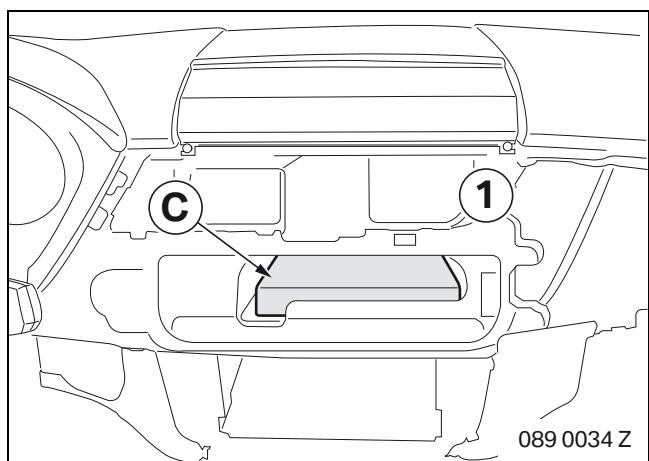
Fissare l'interfaccia **C** alla plancia portastrumenti (1).
